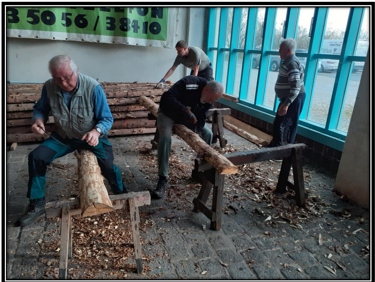
Zurichtung der Ausbauhölzer für den Türstockausbau über den Standort des Traditionsförderhuntes, Foto Eckhard Ehrh
